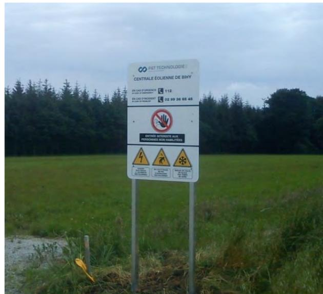
Figure 17 : Exemple de panneau de prévention des risques sur un parc éolien
